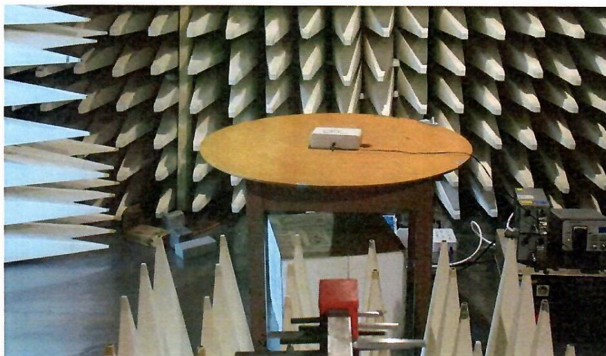
Obrázek 3.2.A – EUT během zkoušek odolnosti proti elektromagnetickému poli
